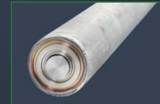
Die Stoßplattenspitze im Kühlschutzmantel
